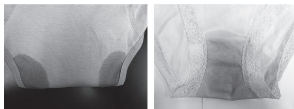
No.2洗濯3回後35mlで染み出し No.8参考品5mlで染み出し
